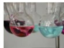
Oltre a essere connessi ad un unico apparato, ogni pallone agisce indipendentemente. Il design di arachno™ è stato attentamente pensato per evitare ogni *cross-contamination* causate da spruzzi tra le diverse miscele.
